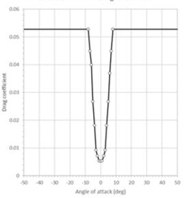
NACA 16016 Airfoil - Drag Coefficient
